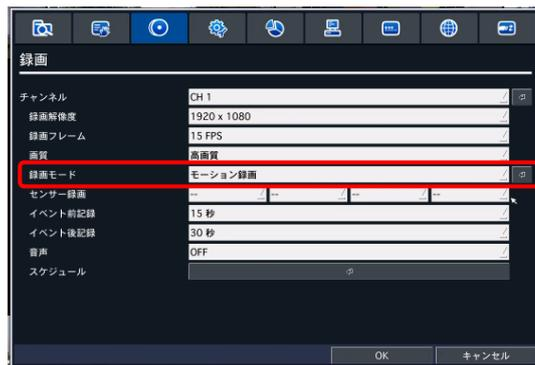
常時録画時の画質とフレームレートを設定しモーション録画時の画質とフレームレートを選択します。これにより常時録画時のハードディスク消費を少なくしモーション時の画質とフレームレートを向上させます。
